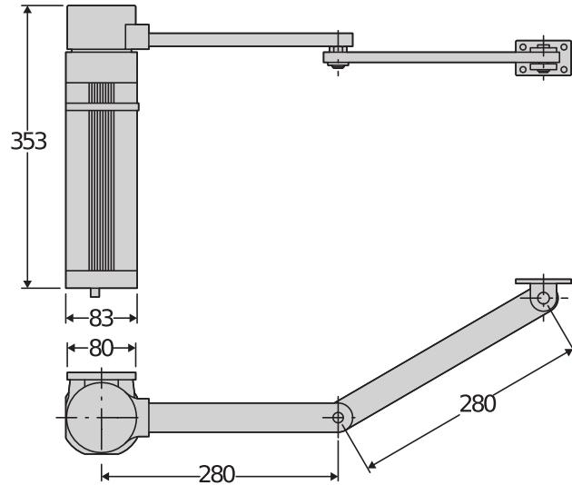
Mesken tipi kullanıma uygun olup, azami 1,8 metre genişliğinde ve 200 kg ağırlığındaki kanatlı bahçe kapılarının otomasyonunu sağlayabilir.
