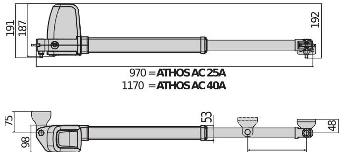
Kalıp döküm alüminyum kovanların yapısı ile sonsuz vida iletim sistemi ve bronz taç gibi yüksek kalitede malzemeler sayesinde Athos operatör ürün yelpazesi zaman içinde maksimum mukavemet, güvenilirlik ve dayanıklılık sağlar.
