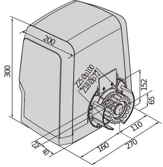
1500 Kg ağırlığa kadar olan kanatlar için uygun yoğun kullanımlı kayar kapılar için 24V operatörlerin ürün aralığı. Manyetik limit svici ve U-Link iletişim protokollü önceden hazırlanmış santraller.
