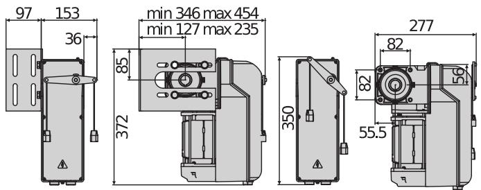
Yarı-yoğun kullanıma yönelik elektromekanik operatör 25 m<sup>2</sup>'ye kadar (Pegaso B Cja 625) veya 45 m<sup>2</sup>'ye kadar olan endüstriyel seksiyonel kapıların otomasyonu için.
