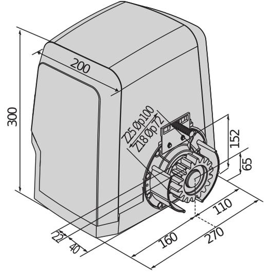
Ağırlığı 1500 Kg.'a kadar yoğun kullanımlı yana kayar kapılar için 24V operatörler ürün aralığı, azami kanat hızı 12m/dak
